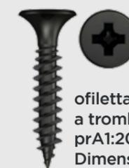
Acciaio al carbonio, temprata e fosfatata nera. Ideale per il fissaggio di pannelli in cartongesso su strutture metalliche. Fissaggio di pannelli in cartongesso per pareti e controsoffitti. Filetto doppio autofilettante, testa svasata con raccordo al gambo a tromba. Marcate CE secondo EN 14566:2008 - prA1:2009. Dimensioni: 3,5 x 25 - diametro dv (mm): 3,5
