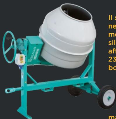
Il sistema di trasmissione inserito nel braccio e il sistema di ribaltamento a vite senza fine le rendono silenziose, leggere, robuste e affidabili. Motore monofase 230V/50Hz. Interruttore IP55 e bobina di sgancio.
