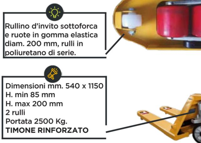
**Rullino d'invito sottoforca e ruote in gomma elastica diam. 200 mm, rulli in poliuretano di serie.**
