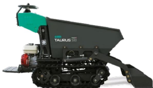
La quantità di olio all'interno del circuito idraulico permette lunghi intervalli di manutenzione. Il freno di stazionamento ad azione manuale va a inibire, tramite un congegno meccanico, il movimento della trazione bloccando la ruota sinistra.
