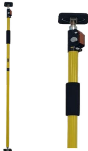
Asta telescopica in metallo alza/ferma lastre "PLUS". Altezza variabile da 1,60 m a 2,90 m. Sollevamento e blocco a cremagliera. Per il bloccaggio della lastra in cartongesso in fase di installazione a soffitto/parete.
