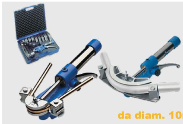
La più piccola nel suo genere e la più maneggevole; nello stesso tempo è molto potente e con il minimo sforzo curva tubi di grande diametro. Ideale per tubi di rame e multistrato con forme e controforme da diam. 10 mm fino a diam. 32mm. Corpo pompa in alluminio pressofuso e acciaio inox a doppio circuito idraulico (kg. 2,3), corsa del pistone particolarmente lunga, leva d'azionamento della pompa registrabile in base alle dimensioni della mano, forme in alluminio pressofuso.
