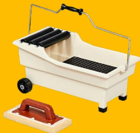
Per eliminare l'eccesso di prodotto sigillante nella fase di sigillatura di pavimenti e rivestimenti. Vasca in plastica antiurto. 3 rulli in plastica su perni in acciaio. L'alta capacità della vasca (20 lt) non richiede frequenti cambi d'acqua. La spugna "Sweepex2" ad altissimo assorbimento garantisce una pulizia perfetta.
