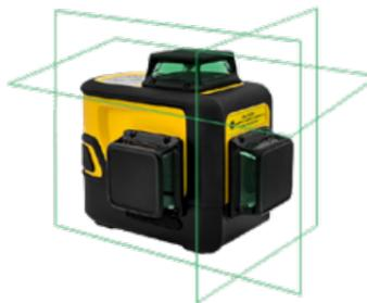
3 linee a 360° ortogonali fra loro, raggi VERDI ad altissima visibilità. Ideale per livellamento orizzontale e allineamento verticale, squadre, piombi e piani inclinati. Precisione +/- 2mm/10m Range operativo diam. 60 metri.
