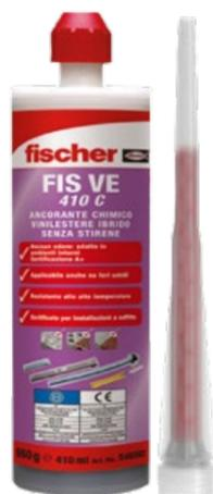
Resina certificata per l'uso in calcestruzzo non fessurato e in muratura. Può essere utilizzata in fori umidi. Il cemento Portland contenuto nell'ancorante chimico consente di mantenere alti livelli di carico per l'intervallo di temperatura compreso tra -40°C fino a +120 °C. L'ampia gamma di accessori assicura grande flessibilità del sistema e consente una vasta gamma di applicazioni. Utilizzo con pistole standard da silicone.
