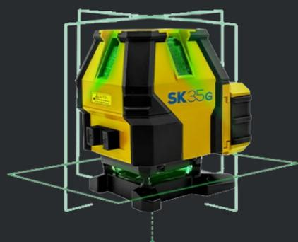
Raggi verdi, 4 linee laser verticali a 90°, singola linea laser orizzontale a 360°, punto di piombo. Dotato di un minitreppiede con piedini regolabili e movimenti orizzontali millimetrici. Range operativo 60 m. Peso 1 kg. Precisione +/- 3 mm/10 m - Durata batterie > 6 ore. Valigia rigida, kit batterie, caricabatterie, treppiede
