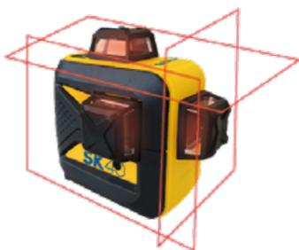
3 linee a 360° ortogonali fra loro, raggi ROSSI ad alta visibilità. Ideale per squadre, piombi pavimento/soffitto, livelli, allineamenti e linee inclinate. Precisione +/- 2mm/10m Range operativo diam. 40 metri.
